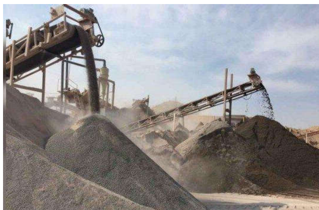
انبار و جداسازی مصالح سنگی از یکدیگر
