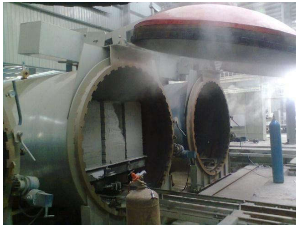
عمل‌آوری بلوک‌ها با بخار آب
